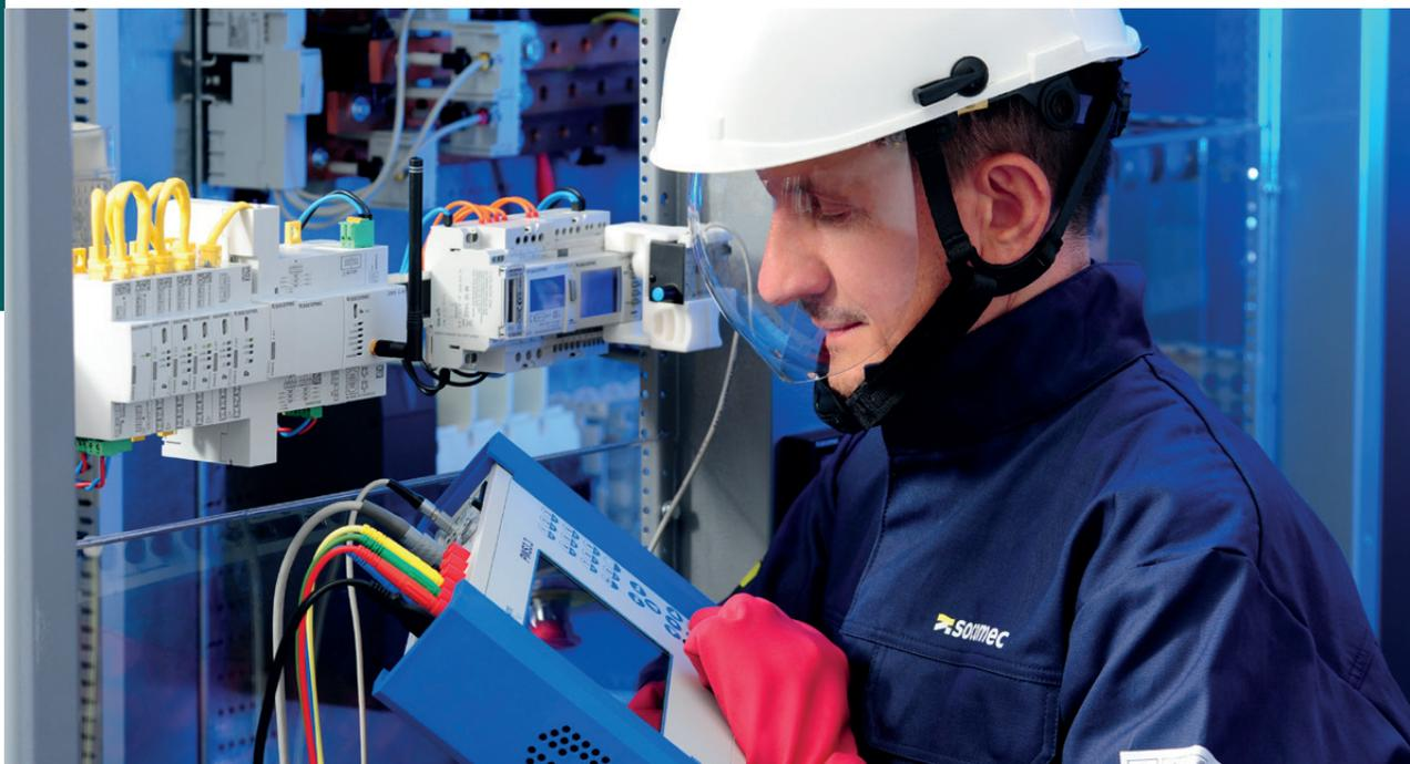
Cette prestation de métrologie consiste à vérifier sur site la précision de comptage d'une installation à 0,2% (précision apportée par l'appareil de mesure), afin d'assurer la fiabilité et la précision d'un système de comptage énergétique (neuf ou existant).
