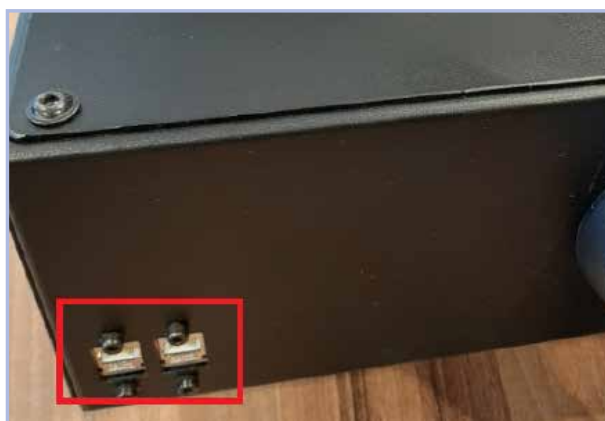
Fig 6. coffret de dérivation - connecteurs RJ45 externes DIRIS Digiware
