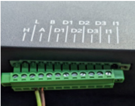
Image 4 : Exemple de connecteur pour le GBMS de la batterie Vision
