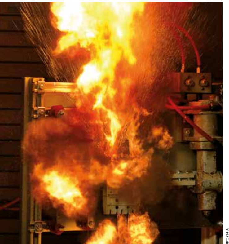
Neuer 250-A-Trennschalter nach aktueller Bauart, geprüft bei 18 kA und 415 V AC. Höhe des Ausgasungsstrahls: 3 m – Icu des geprüften Trennschalters: 36 kA.
