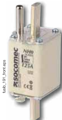
gG-Sicherung, NH0, mit Schlagbolzen von 16 bis 200 A
