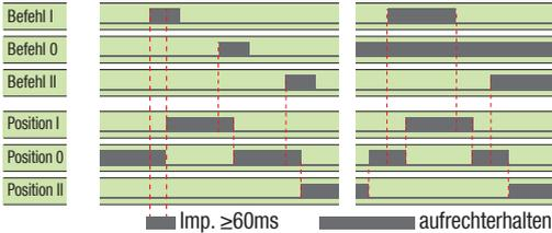
Schließen Sie Kontakt 312 mit Kontakt 317, um die Steuerung zu ermöglichen. Schließen Sie Kontakt 316 mit Kontakt 317, um die Schaltschützlogik zu aktivieren. Schließen Sie den entsprechenden Kontakt, um die gewünschte Position zu erreichen. Schließen Sie Kontakt 313 mit Kontakt 317, um das Produkt in die Position Priorität 0 zu zwingen.
