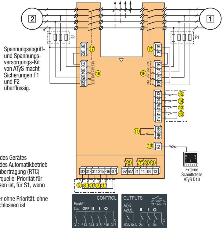
Spannungsabrgriff- und Spannungsversorgungs-Kit von ATyS macht Sicherungen F1 und F2 überflüssig.
